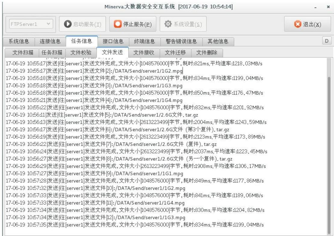
InfiniBand 的传输速度理论可以达到 100Gbps 以上，实际测试速度能达到 10Gbps 以上（与服务器硬件平台性能相关），支持双向同步传输，完全能满足各行业用户的传输速率需求。支持超大文件的稳定传输，能稳定传输 100G 以上的大文件。
